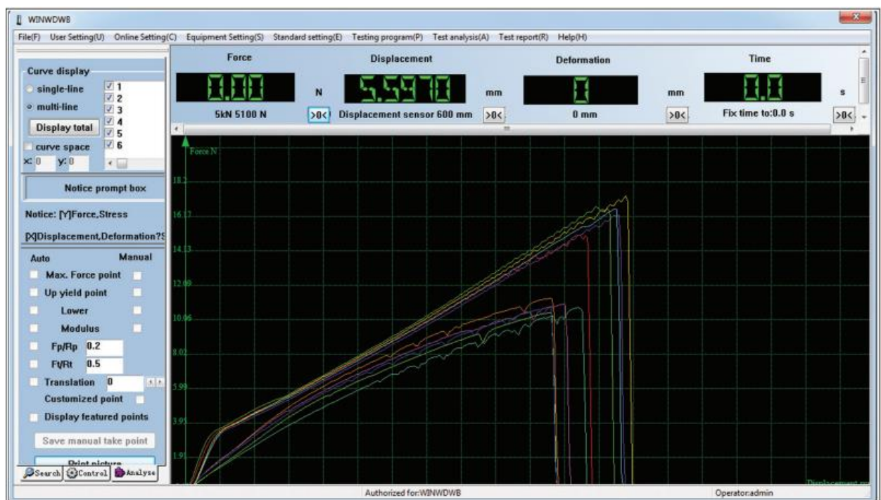
Figura 2 Diagrama computadorizado de tensão de amostras de cone de guta-percha;
