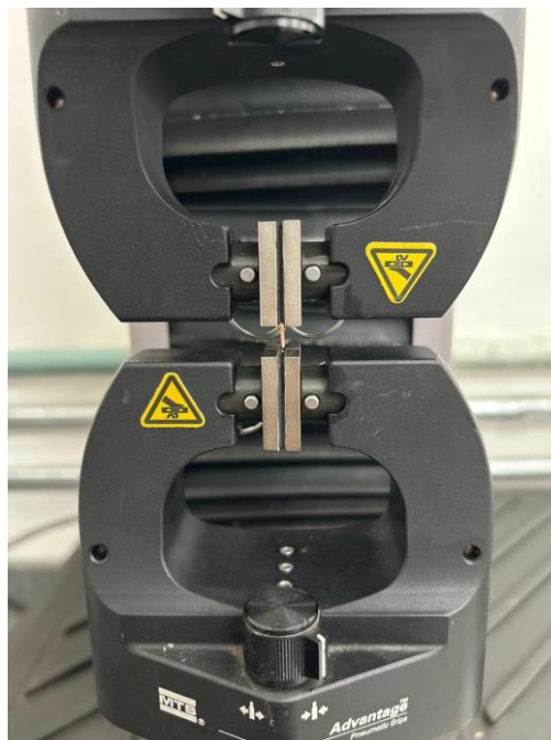
Figura 11 Ensaio de resistência de tração gerados sobre os corpos de prova GP
