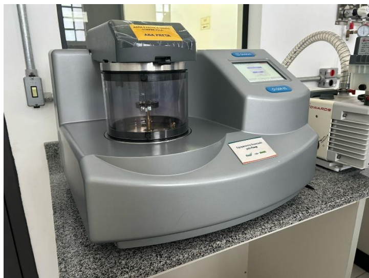
Figura 8 Equipamento para a deposição de filme metálico em ambiente de vácuo, equipamento Sputter Coater Quorum Q150T Es. FONTE: Próprio autor
