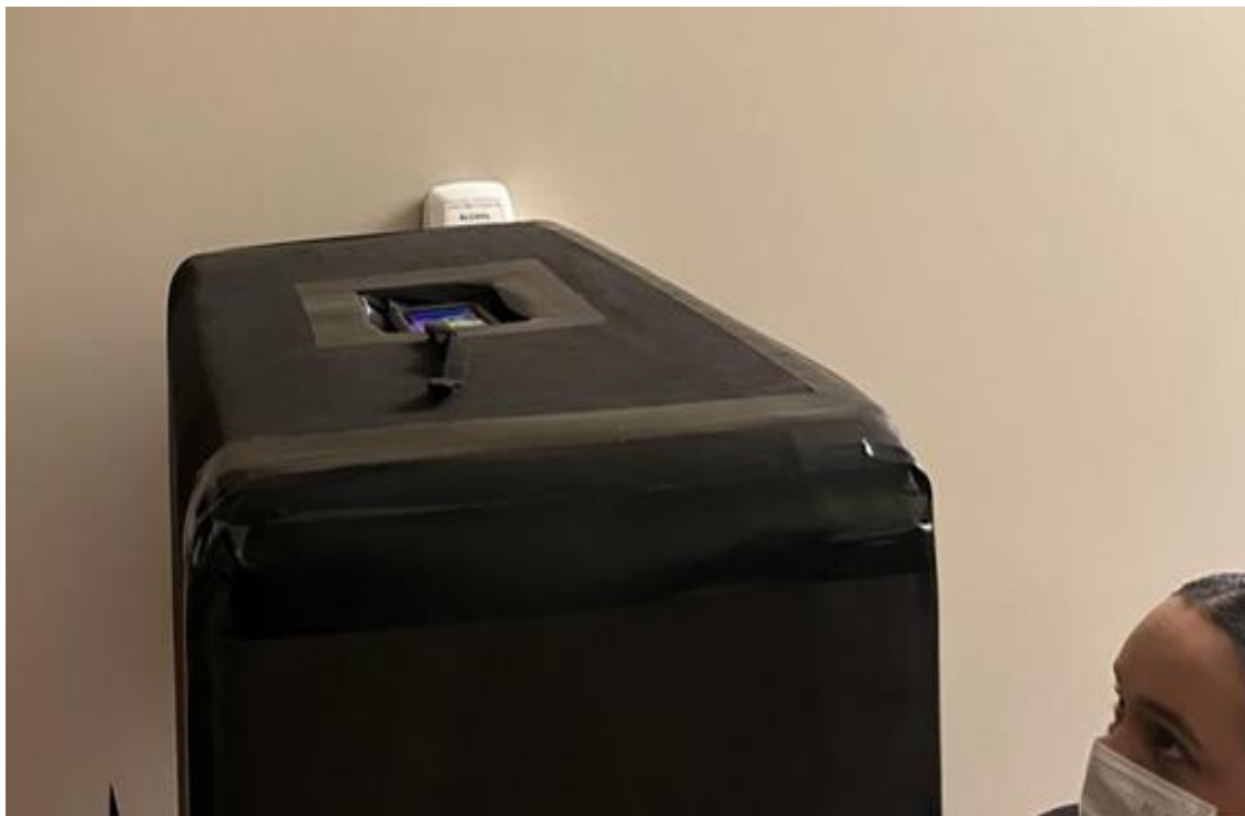
Figura 6: Cabine de teste com abertura central na parte superior para encaixe da máquina termográfica.
